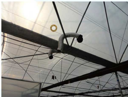
充气风机 Inflation blower AC220V 50Hz 12w
